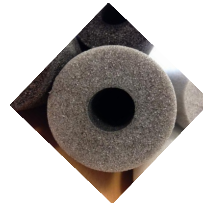
Optimeret skumprodukt, hvor isoleringseffekten øges op til 15% ved hjælp af de rette tilsætningsstoffer.
