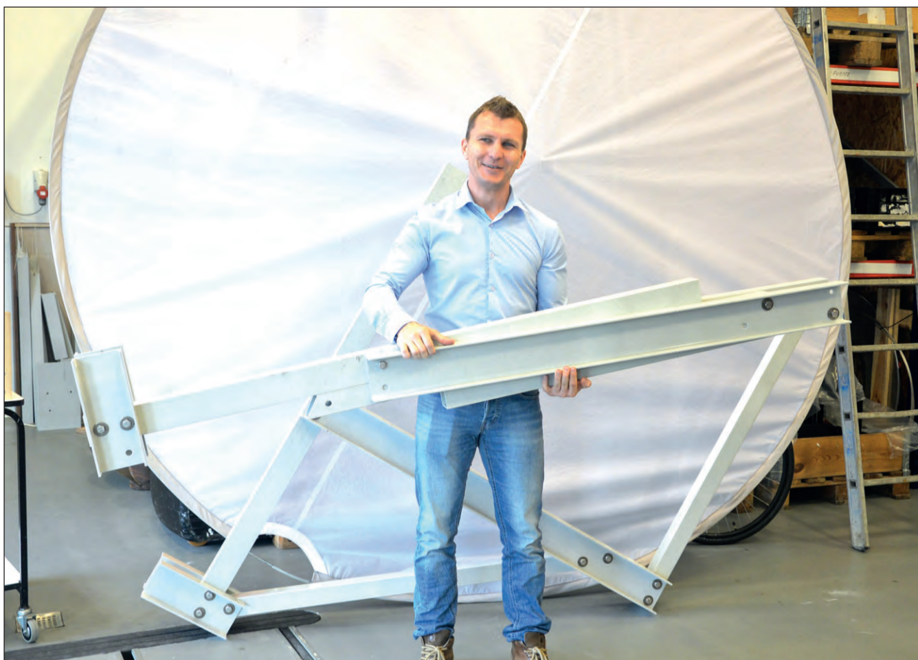
Product Manager hos Fiberline Mirfjet Malagic har været involveret i udviklingen af de sammenklappelige hyldeknægte (løsning 2), og bag ved ham er en udslået version. Hyldeknægtene er fremstillet af kompositmateriale, og platformsdækket
